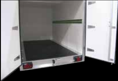
• Surraskinner montert innvendig vegg
